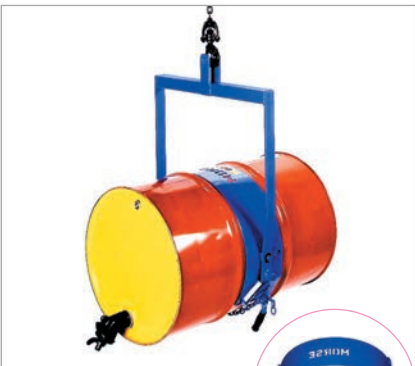
Collare di presa a tre elementi posto sul ribalta fusti cod. 414 001 389
