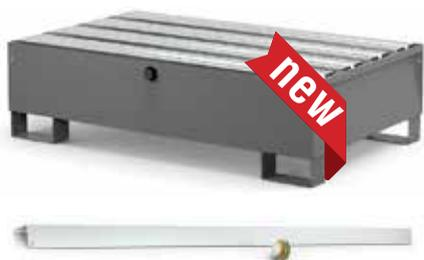
Vasca di contenimento con capacità di 200 litri, con un sistema a doghe per il sostegno dei fusti. Le staffe poste sotto alla vasca facilitano gli eventuali spostamenti mediante transpallet o carrello elevatore. Durante il trasporto o in caso di inutilizzo le vasche possono essere impilate per risparmiare spazio.
