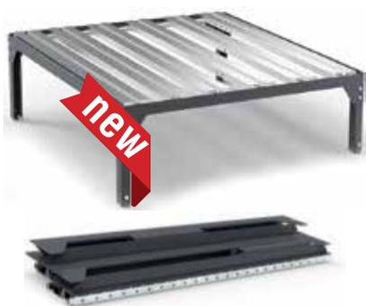
Il kit supporto inclinato per cisterna, composto da una struttura metallica di colore grigio antracite e doghe con pettini zincati, permette di porre una cisterna sopra una vasca di contenimento in posizione inclinata, per favorire le manovre di spillatura. Per il trasporto, o se non utilizzato, può essere smontato per occupare uno spazio ridotto di 1300 x 170 mm con 140 mm di altezza.
