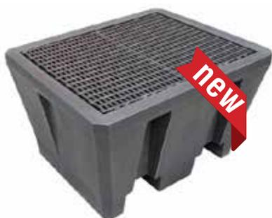
Vasche di contenimento, piattaforme e supporti stampati a rotazione in un unico blocco di polietilene ad alta densità. Ideali per lo stoccaggio in sicurezza di fusti. Compatibili con un gran numero di prodotti chimici. Impilabili a vuoto e complete di griglia in polietilene amovibile per facilitarne le operazioni di pulizia.
