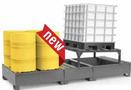
Vasca di contenimento con capacità totale di 1.100 litri, con un sistema di pettini e doghe per il sostegno dei fusti. Le vasche sono collegate con un kit di accoppiamento che permette la creazione di un sistema modulare per il collegamento di più vasche. Durante il trasporto o in caso di inutilizzo le vasche possono essere impilate per risparmiare spazio prezioso ed i supporti per cisterna possono essere smontati e riposti all'interno della vasca.
