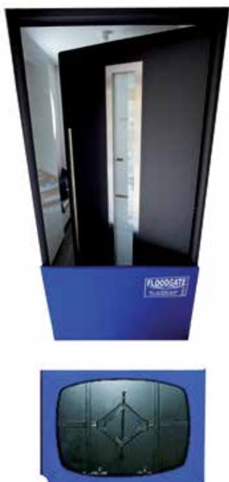
FLOODGATE è un semplice e rapido sistema di sbarramento per porte e finestre di edifici industriali e abitazioni, da utilizzare in caso di esondazioni di piene fluviali. È costituito da un telaio in acciaio di spessore 25 mm, avvolto da una guaina spessa 7 mm di neoprene e si espande telescopicamente sul piano orizzontale e verticale per adattarsi in modo semplice e sicuro in una vasta gamma di telai di porte.
