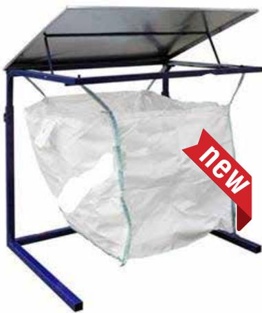
Struttura tubolare di acciaio al carbonio verniciato RAL 5012. Provvisto di appositi ganci interni dove fissare le bretelle del big bag. Copertura sagomata, incernierata e regolabile per garantire massima funzionalità. Utilizzabile per lo stoccaggio di sacconi o big bag dal carico massimo di 1000 lt.
