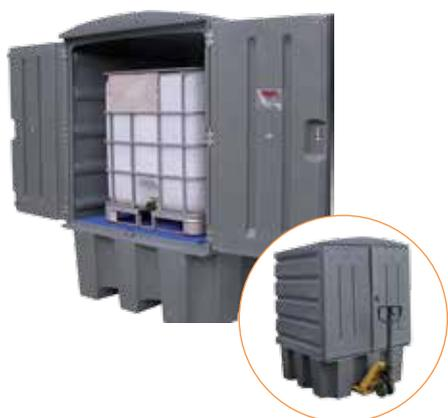
Armadio dotato di vasca di raccolta interna. Doppia porta a battente fissata con cerniere in INOX e chiusura a chiave. Soluzione ideale per lo stoccaggio di prodotti corrosivi. Adatto al posizionamento di 1 cisternetta da 1000 L o 4 fusti da 200 L.
