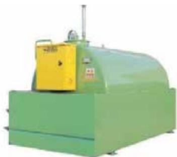
I serbatoi sono del tipo ad asse orizzontale, cilindrici, costruiti con fondi bombati e lamiera calandrata in acciaio al carbonio S 235 JR UNI EN 10025, assemblati mediante processo di saldatura ad arco sotto protezione di gas e successivamente trattati con uno strato di antiruggine ed uno strato di smalto a finire di colore verde; sono collaudati a tenuta mediante prova pneumatica. I Serbatoi sono inoltre dotati di un sistema di erogazione.
