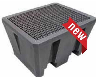
Vasche di contenimento, piattaforme e supporti stampati a rotazione in un unico blocco di polietilene ad alta densità. Ideali per lo stoccaggio in sicurezza di fusti. Compatibili con un gran numero di prodotti chimici. Impilabili a vuoto e complete di griglia in polietilene amovibile per facilitarne le operazioni di pulizia. Sicure, resistenti, imputrescibili e maneggevoli.
