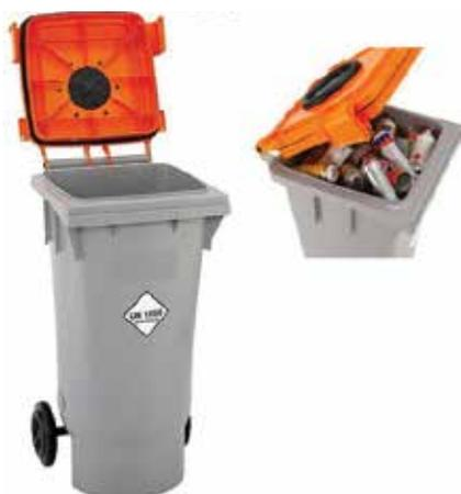
Contenitore omologato realizzato in plastica antistatica per raccolta bombolette spray vuote o parzialmente vuote. Apertura superiore per inserimento bombolette spray anche con coperchio chiuso, coperchio con guarnizione in gomma perimetrale e sistema di bloccaggio, ventilazioni laterali integrate per la circolazione dell'aria, portata fino a 150 kg. In dotazione panno assorbente (da posizionare sul fondo) per eventuali fuoriuscite di liquidi e adesivi di segnalazione "UN 1950".
