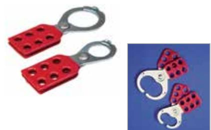
Questi dispositivi consentono il bloccaggio della fonte di energia a 6 differenti operatori, in acciaio inossidabile rivestito in vinile, antiruggine. Compatibili con lucchetti con arco max. 9,5 mm di diametro.
