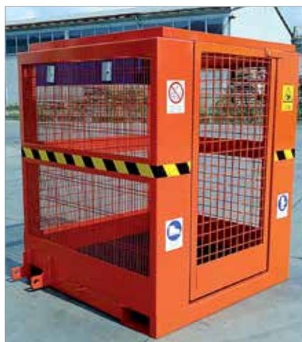
Cestello per la manutenzione aerea con porta a molla e dispositivo di bloccaggio, dotato di fermo di sicurezza che evita lo sfilamento del contenitore dalle forche e di ganci per l'attacco delle cinture di sicurezza. Completo di tappetino antiscivolo e vaschetta porta-attrezzi.
