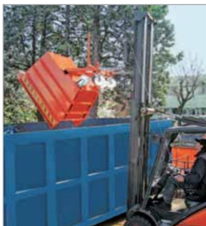
Contenitori specifici per la raccolta di rifiuti, sfridi e rottami. Inforcabili direttamente con carrello elevatore; facilmente ribaltabili dall'operatore mediante una leva per svuotarne direttamente il contenuto senza scendere dal carrello. Questo sistema di svuotamento permette di eliminare le perdite di tempo ed i rischi di infortuni. Ideali per carpenterie, rettifiche, fonderie, vetrerie, falegnamerie, ecc...
