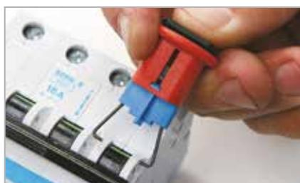
Sistema efficace per il bloccaggio degli interruttori magnetotermici Europei. Si installa semplicemente con l'aiuto di un pulsante a pressione. Il mod. TBLO ha invece una pratica rotella di chiusura a vite per un'applicazione veloce. Robusto, in nylon caricato con fibra di vetro. Da utilizzare in combinazione con un lucchetto con l'arco da 6 mm di diametro.
