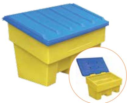
Costruito in un unico blocco di polietilene ad alta densità trattato anti UV, anticorrosivo, resistente a numerosi prodotti chimici e agli urti. La forma ed il materiale in cui è costruito lo rendono adatto all'uso esterno, è dotato di coperchio incernierato ad apertura totale e di passaggio per le forche del carrello elevatore per facilitarne la movimentazione. Adatto per diverse applicazioni tra le quali lo stoccaggio di sabbia, sale e prodotti assorbenti.
