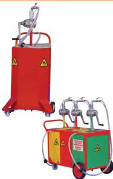
Sistemi mobili di estrazione che permettono il trasferimento dei carburanti (benzina e diesel) in tutta sicurezza da un unico operatore.
