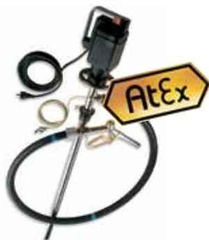
Pompa per prodotti altamente infiammabili come etanolo, benzine, butanolo, isopropanolo, kerosene, metanolo e petrolio. Tipologia motore elettrico: MA II 3, 460 W, con ventilazione esterna. Tipologia motore pneumatico: MD - 2, 400 W / 6 bar. Normative antideflagrante secondo direttive 94/9/EC- ATEX 100°, categoria 2.
