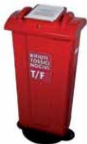
Contenitore in polietilene costruito con la tecnica rotazionale per garantire resistenza agli urti, all'invecchiamento e allo scolorimento. Il coperchio è in ABS termoformato e bloccato al contenitore mediante serratura a triangolo completo di sportello antintrusione. Lo svuotamento avviene tramite sacchetto di spessore idoneo per garantire all'operatore totale sicurezza nell'operazione. Il basamento è in polietilene zavorrabile anch'esso costruito con tecnica rotazionale pesa 18 kg.
