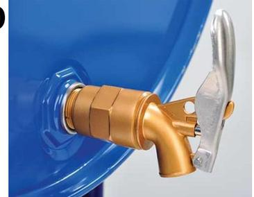
I rubinetti sono accessori utili per eseguire in sicurezza le operazioni di prelievo di liquidi contenuti all'interno di fusti orizzontali, i rubinetti per i fusti sono realizzati in relazione alla tipologia di fluido da trattare, essi differiscono per tipologia del materiale di costruzione, caratteristiche tecniche e sistemi di chiusura. Questa scheda si riferisce ai rubinetti in lega di alluminio.
